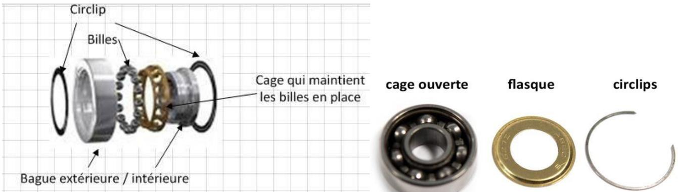
On a 2 roulements par roues séparés par une entretoise (pièce métallique qui maintient l'espace entre les roulements et évite que le serrage de l'axe de la roue empêche celle-ci de tourner par frottement).
